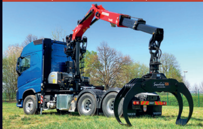
Fassi F660 s nekonečnou otočí a systémem vzdálené diagnostiky přes internet
