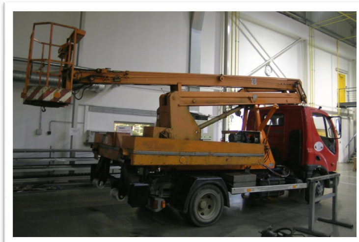
Automobil s nosičem kontejnerů a kontejnerovou pracovní plošinou
